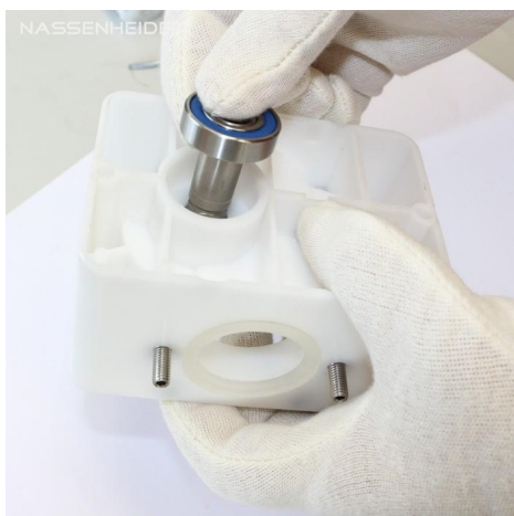
Фиг. 9: Поставете задвижващия вал
