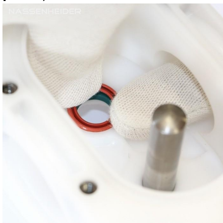
Фиг. 8: Поставете червено / синьо, смазано уплътнение на вала
