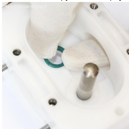
Фиг. 7: Поставете зелено / синьо, смазано уплътнение на вала
