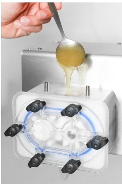
Фиг. 12: Пълнене главата на помпата
